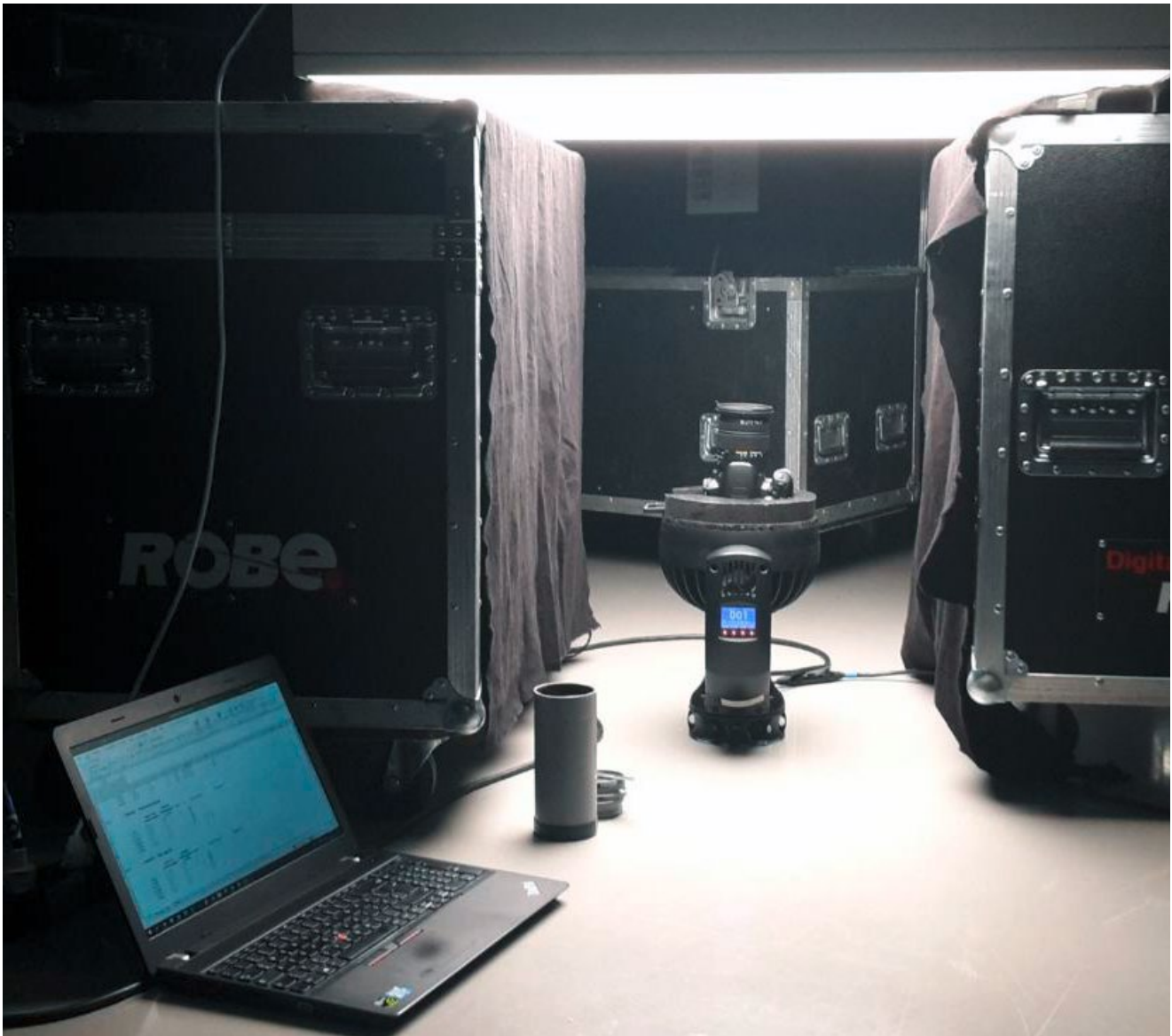
ABBILDUNG 7 Messaufbau zur Ermittlung des optimalen Abstandes des Schattengebers, diffuses Licht
