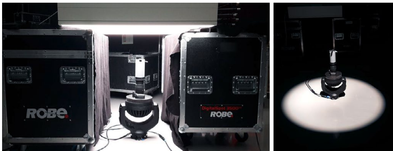
ABBILDUNG 11 Messaufbau zur Messung des Härtegrades; links diffuses Licht, rechts gerichtetes Licht
